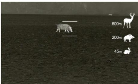
Die AFFO-Serie unterstützt die Sichtlinien-Entfernungsmessfunktion, mit der der Benutzer die ungefähre Entfernung zu einem Objekt mit bekannter Größe schätzen kann.
