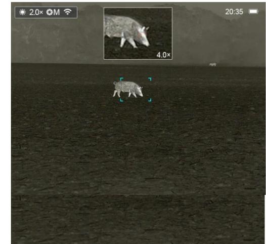
Bildschirm. Das Bild im separaten Fenster ist das zweifach vergrößerte Bild, das durch den blauen Kasten im Hauptbild erfasst wird, wenn die Laseranzeige eingeschaltet ist, zoomen Sie mit dem Lasercursor als Mittelpunkt hinein.
