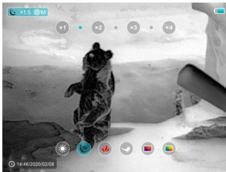
Bildmodus im Kontextmenü 1 zu wechseln; die Symbole von links nach rechts sind White hot, Black hot, Red hot, Hot target highlight, Ironbow und Regenbogen.
