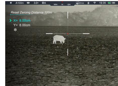
das Absehen mit dem Treffpunkt übereinstimmt. Drehen Sie im Uhrzeigersinn, um das Absehen nach links oder unten zu bewegen, und drehen Sie gegen den Uhrzeigersinn, um es nach rechts oder oben zu bewegen.
