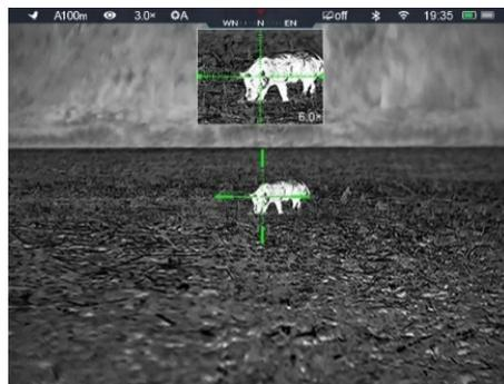
wird gleichzeitig das im PIP-Fenster angezeigte Bild 2x vergrößert.
